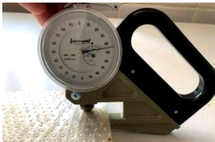
Рисунок 5.19 – Определение толщины геомембраны механическим толщиномером
