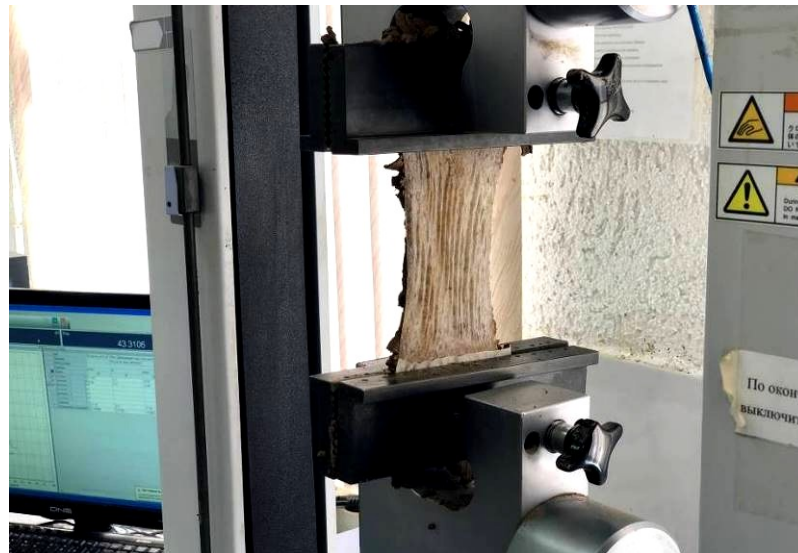
Рисунок 5.11 – Испытание ПФЭ, совмещенного с геомембраной
