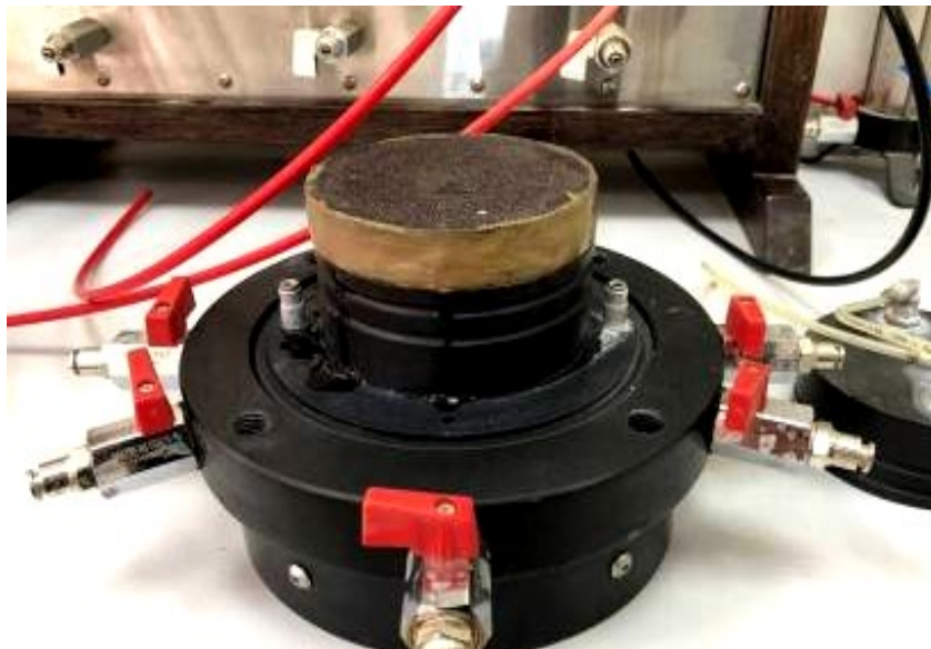
Рисунок 5.14 – Подготовка к испытанию образцов ПФЭ из бентонитового материала
