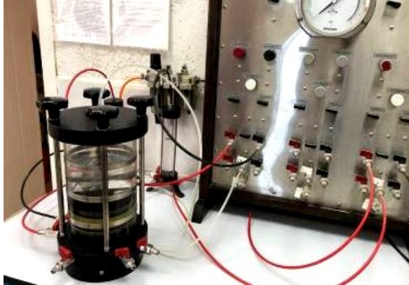
Рисунок 5.15 – Исследование коэффициента фильтрации образцов ПФЭ из бентонитовых материалов
