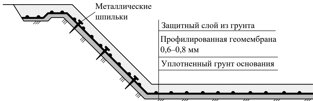
Рисунок 2.16 – Конструкция противофильтрационного экрана из профилированной геомембраны с защитным покрытием из грунта
