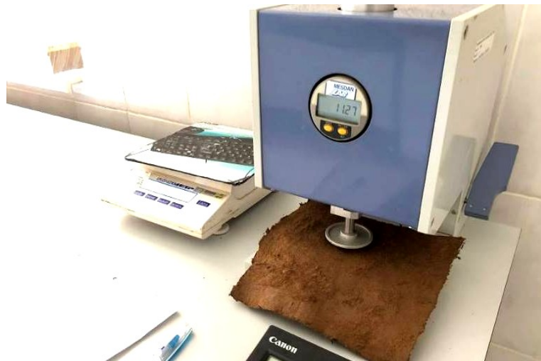
Рисунок 5.18 – Определение толщины образцов геосинтетических бентонитовых материалов
