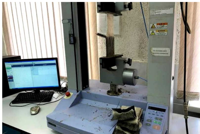
Рисунок 5.6 – Испытания заводских бентонитовых материалов на раздир
