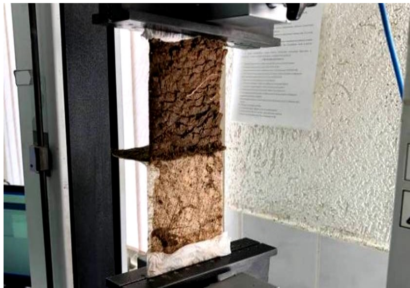
Рисунок 5.9 – Процесс испытания эксплуатируемого ПФЭ на раздир
